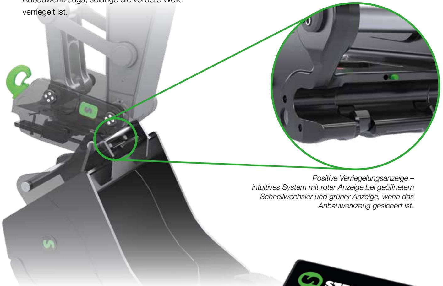
*Positive Verriegelungsanzeige – intuitives System mit roter Anzeige bei geöffnetem Schnellwechsler und grüner Anzeige, wenn das Anbauwerkzeug gesichert ist.*
