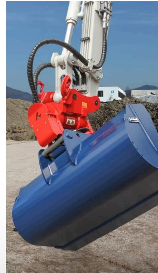
Rotator mit baggerseitiger SW-Aufhängung (Sandwich)
