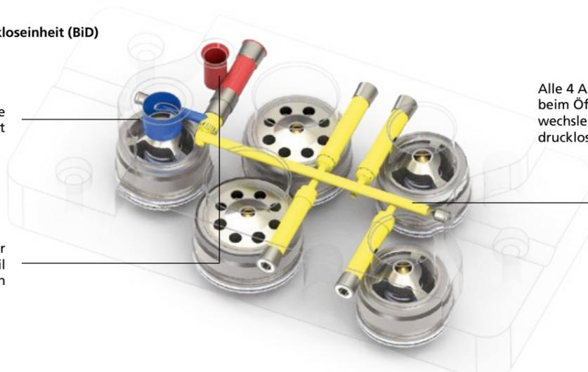
Alle 4 Arbeitsventile werden beim Öffnen des Schnellwechslers über diese Leitung drucklos geschaltet
